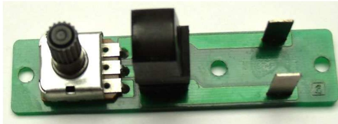
Diodenkörper kann jetzt nach oben abgezogen werden
