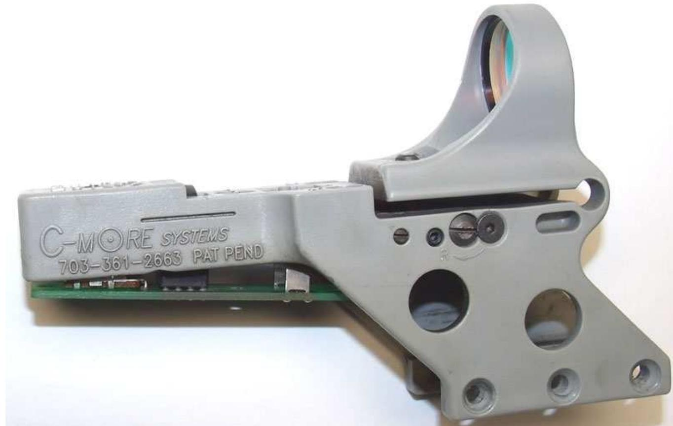
Platine nach unten aus dem Gehäuse drücken
