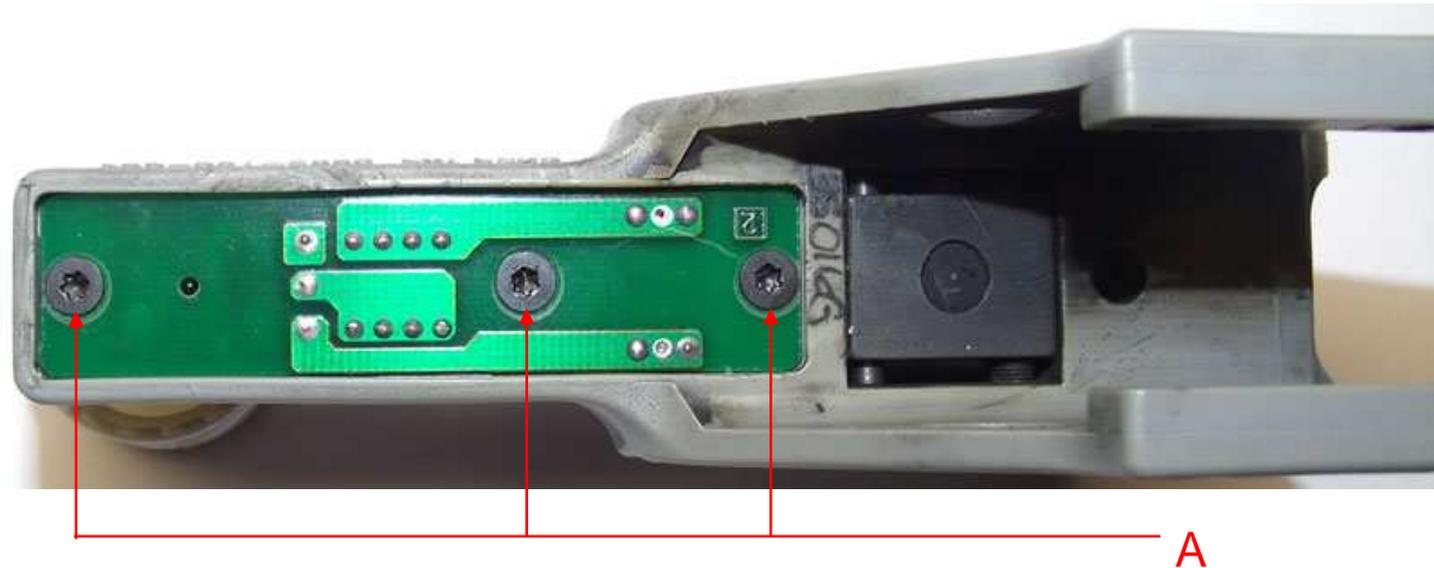
Platine ist mittels Torxschrauben mit dem Gehäuse verbunden
